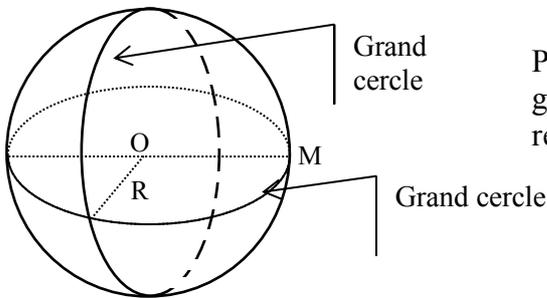
Pour donner l'impression de volume, on trace deux grands cercles à diamètres perpendiculaires, que l'on représente par des ellipses.
